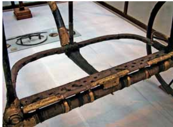
Eje y bastidor del suelo del carro A6 de la tumba de Tutanjamén. Se aprecia como el timón del carro se dobla y pasa por debajo del suelo -originalmente de tiras de cuero trenzadas- para dar mayor rigidez al conjunto. El eje en el extremo trasero del carro da más estabilidad al vehículo. Museo del Cairo. Foto: autor.
